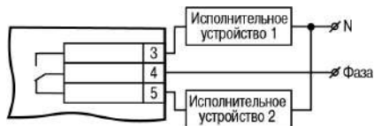
Рисунок 5.7 – Схема подключения нагрузки к ВУ типа Р
